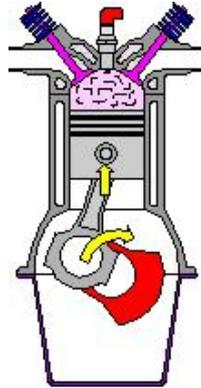
3.- Explosión: En el instante que finaliza la carrera de compresión, se produce la inflamación de la mezcla por medio de una chispa que salta en la bujía. La inflamación de la mezcla produce una violenta explosión, este fuerte aumento de la presión provoca que el pistón sea empujado violentamente hacia abajo.
