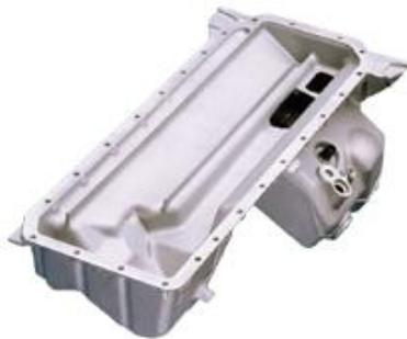
Parte inferior del motor que se usa como depósito de aceite.
