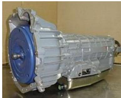
El movimiento del motor se transmite en forma rotatoria a la caja de cambio, estos elementos se acoplan y desacoplan por medio del sistema de embrague. De la caja de cambios se transmite por medio de ejes (junta homocinética), tracción delantera o eje cardan (tracción trasera). La transmisión final es mover en forma rotatoria las ruedas motrices.
