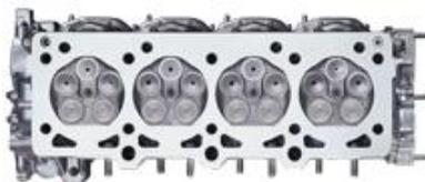
Robusta pieza superior que contiene una cámara de explosión para cada cilindro; en el interior de cada una de ellas están las válvulas de admisión, por donde llega la mezcla de aire-gasolina a los pistones, y las de escape, por donde salen los gases procedentes de la combustión una vez conducido el ciclo. La culata lleva hilo para alojar a las bujías que provocan la chispa eléctrica.
