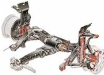
Para conducir en forma cómoda, absorber las irregularidades del camino, depende de varios elementos que son: espiral, amortiguador, barra estabilización, pieza oscilante y paquete de resorte o amortiguadores.
